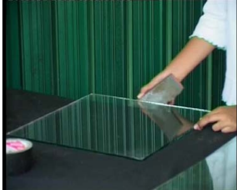
Gambar 2.28. Menghaluskan bagian pinggir kaca
